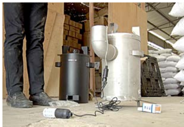
Jiko ya umemejoto inayotumia vidonge kutoa kawi pamoja na umeme tosha kuwasha jiko na balbu pamoja na kujaza moto kwa simu. PICHA: MOSES WEKESA, KNA
